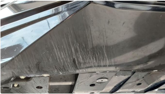
1.2 Noe oppripet på underside av fanger foran. Normal slitasje
