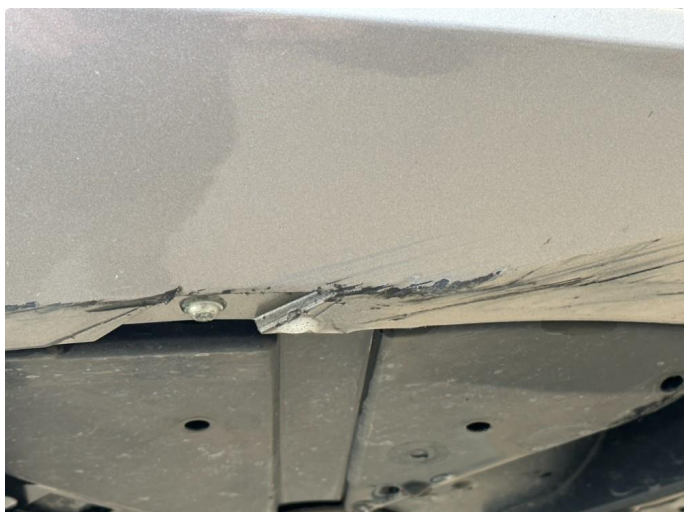
1.1 Litt oppripet på underside av fanger foran
