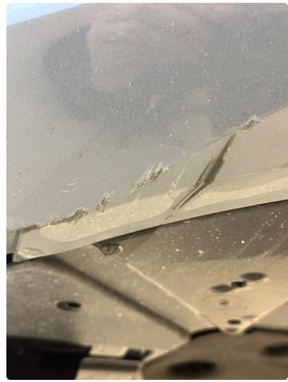
1.2 Litt oppripet på underside av fanger foran
