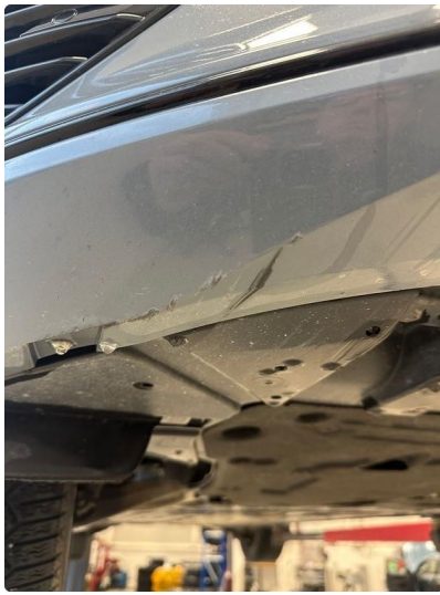
1.2 Litt oppripet på underside av fanger foran
