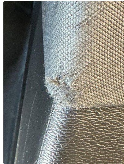
2.1 B-pilar-deksel litt slitt. Venstre side
