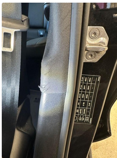
2.1 B-pilar-deksel litt slitt. Venstre side
