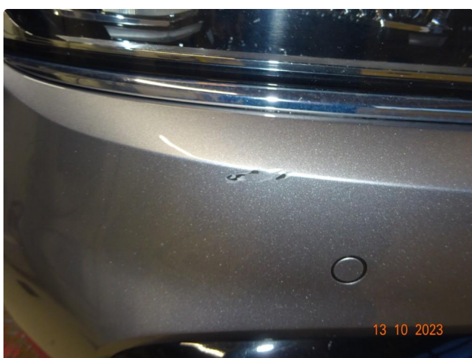
1.4 Ripe(r) ned til grunning
