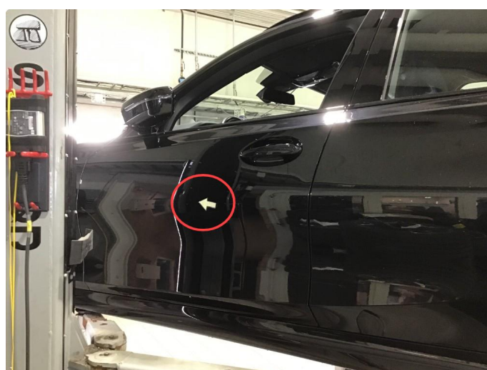
1.2 2 små p-bulker v-fremdør, regnes som normal bruksslitasje.
