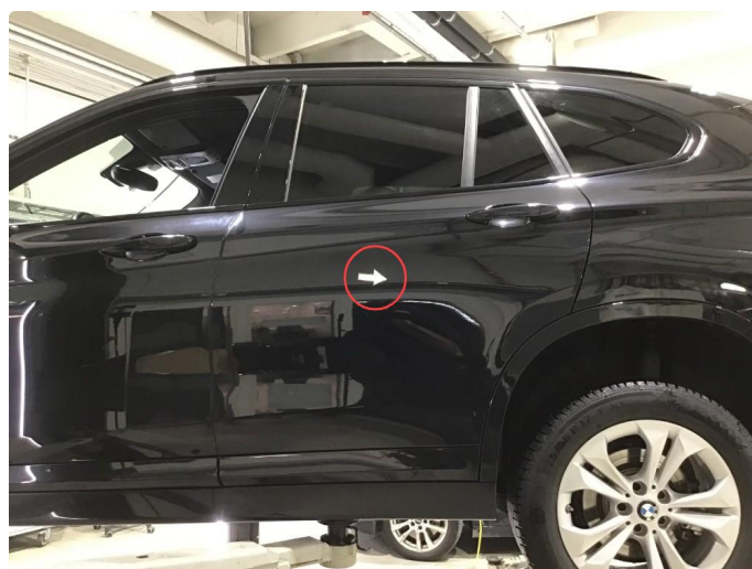
1.2 Liten p-bulk v-bakdør, regnes som normal bruksslitasje.
