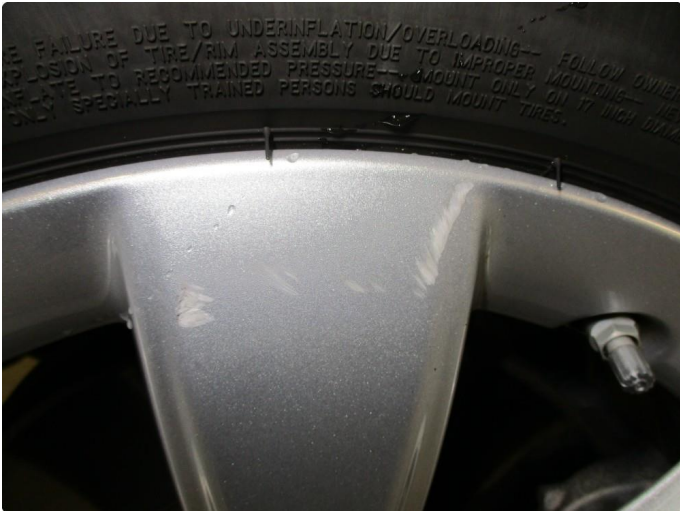
1.1 Ripper på en sommerfelg - normal bruksslitasje
