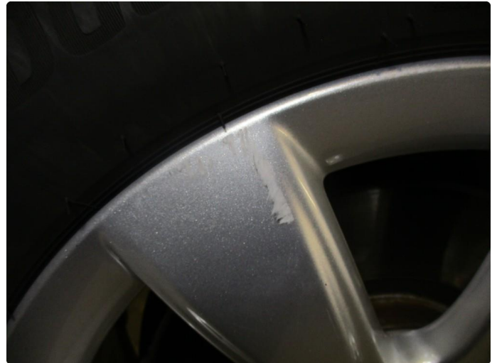
1.1 Ripper på en sommerfelg - normal bruksslitasje
