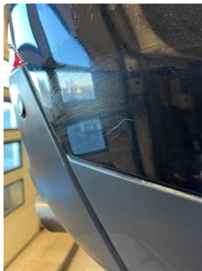
1.1 Ripe(r) ned til grunning
