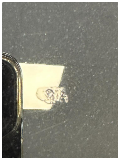
1.1 Noen steinsprut i panser/fanger foran
