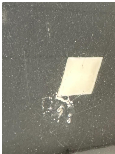
1.1 Noen steinsprut i panser/fanger foran
