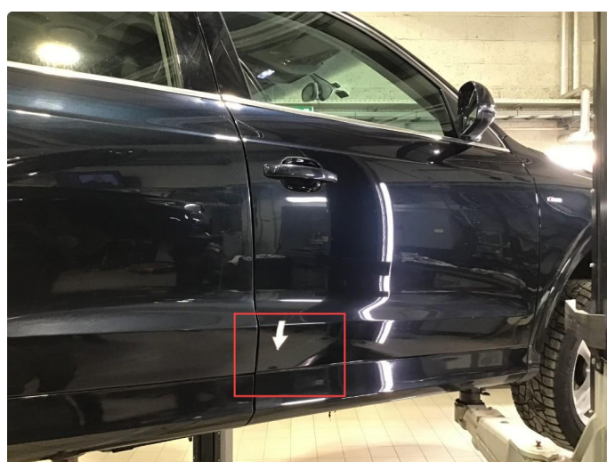
1.2 H-framdør er trolig opplakkert, da det er noe forskjell i lakkstruktur.
