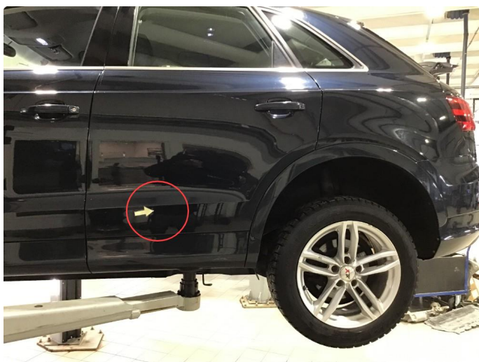
1.3 Liten p-bulk v-bakdør, normal bruksslitasje.
