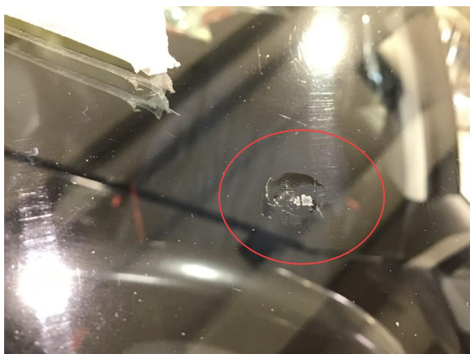
1.7 Steinsprut, reparert tidligere.
