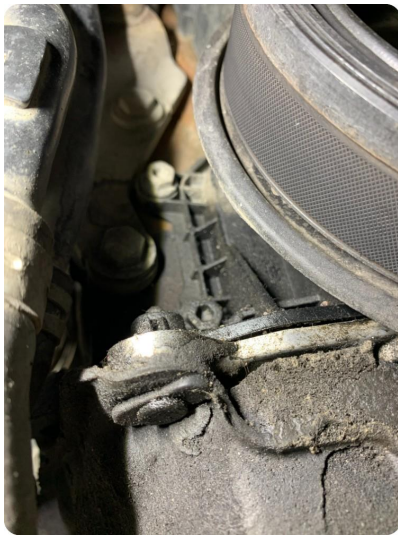
3.1 Oljelekkasje i forkant Oljelekkasje ved tettestres på register
