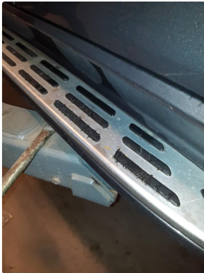
1.1 Litt slitasje på stigtrinn
