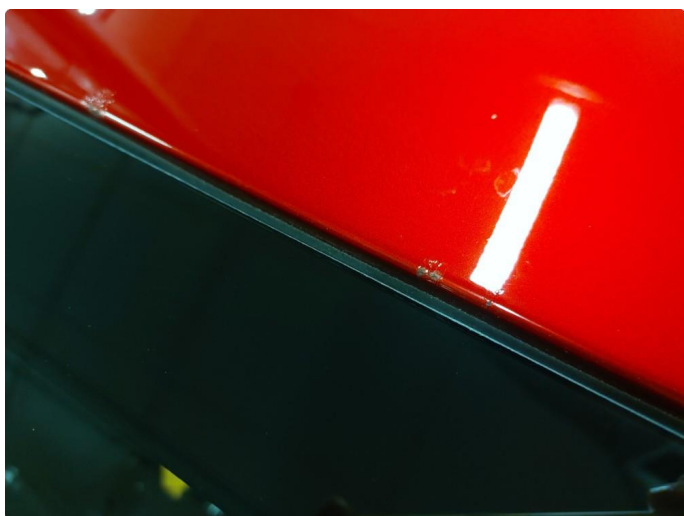
1.6 Steinsprut med rust
