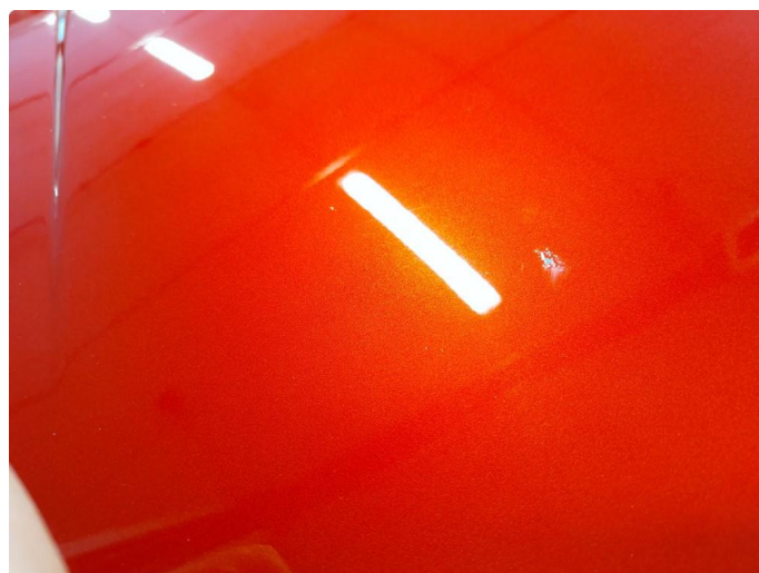
1.6 Steinsprut med rust
