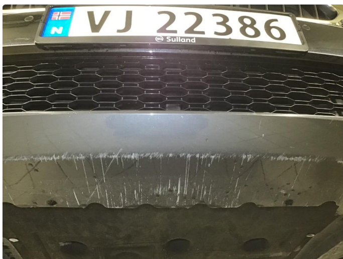
1.4 Skrubbemerker underkant fremfanger, regnes som normal bruksslitasje.
