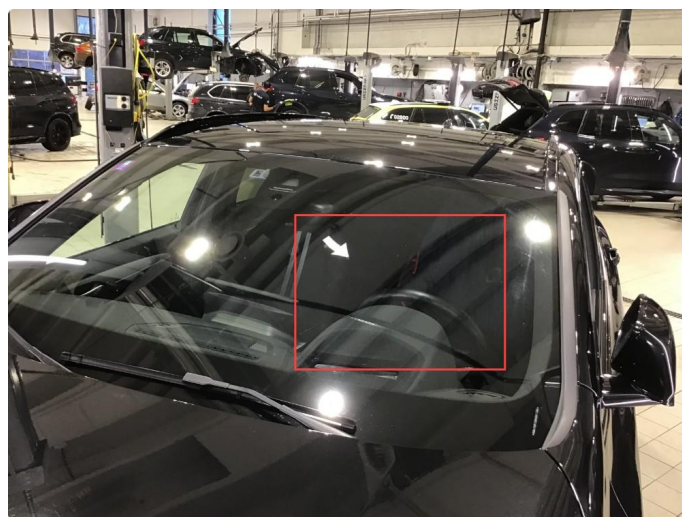
1.5 Noe steinsprut frontrute, for små til å repareres.
