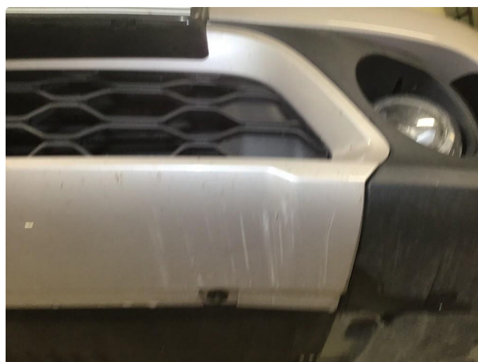
1.5 Noe skrubbermerker underkant frontfanger, normal bruksslitasje.
