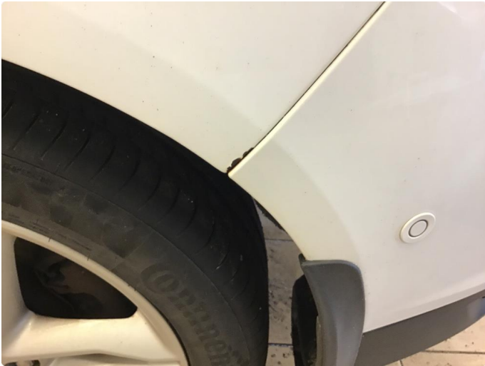
2.1 Antydning til rust på skjerm.
