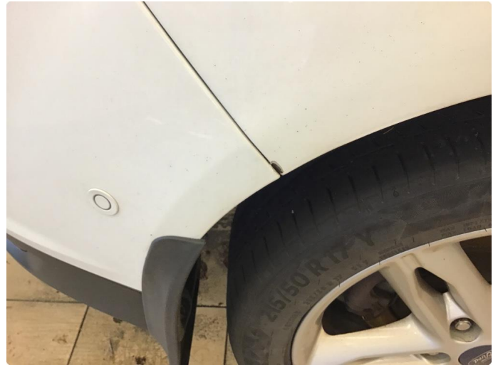
2.1 Antydning til rust på skjerm.
