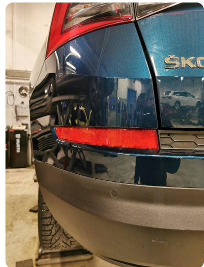
2.3 Skadet Skprekker i refleks
