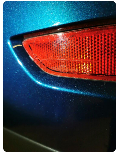
2.3 Skadet Skprekker i refleks
