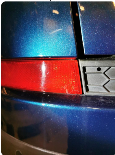
2.3 Skadet Skprekker i refleks
