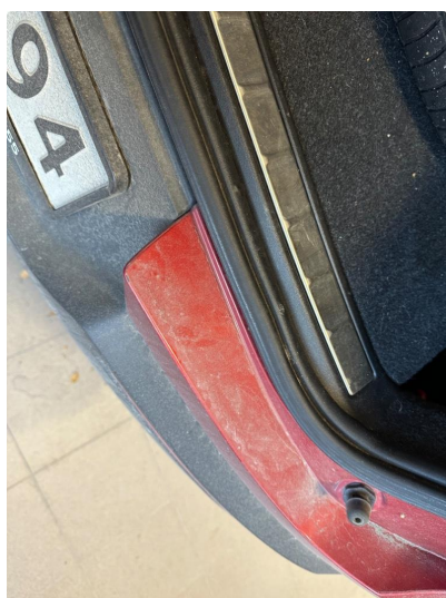
1.2 Noen småskader innlastingssone bagasjerom
