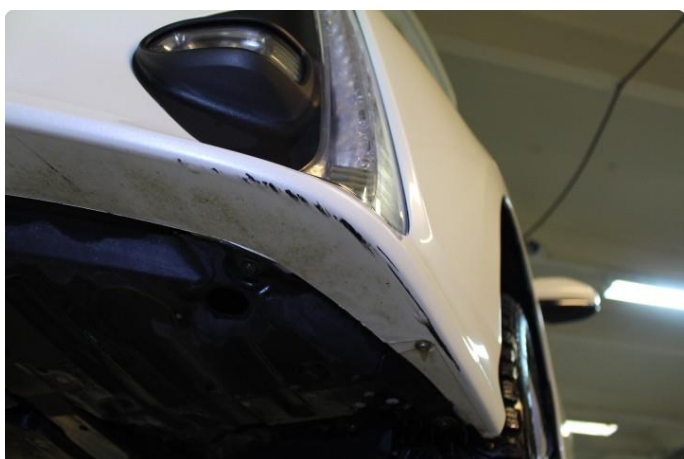
1.2 Noen skrubbskader og riper på støtfanger.
