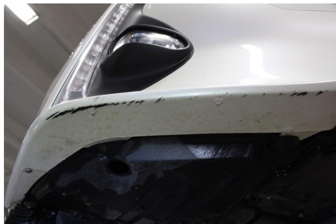
1.2 Noen skrubbskader og riper på støtfanger.
