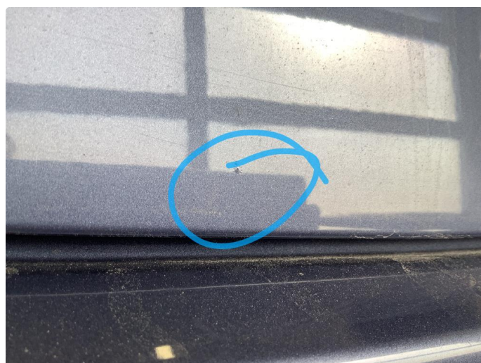
2.2 Steinsprut med rust
