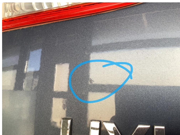
2.2 Steinsprut med rust
