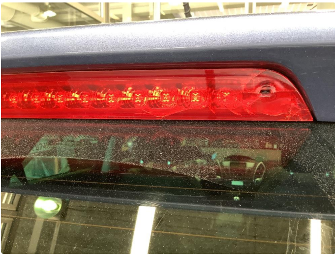
3.1 Krakelering i plast
