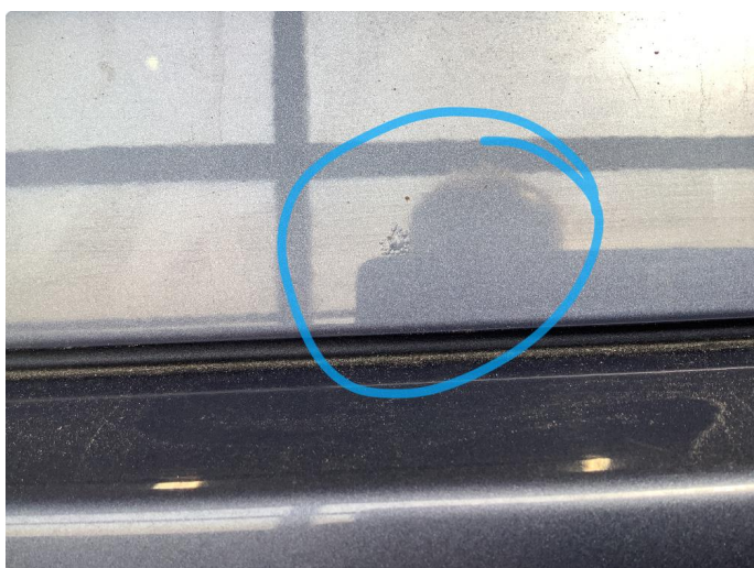
2.2 Steinsprut med rust
