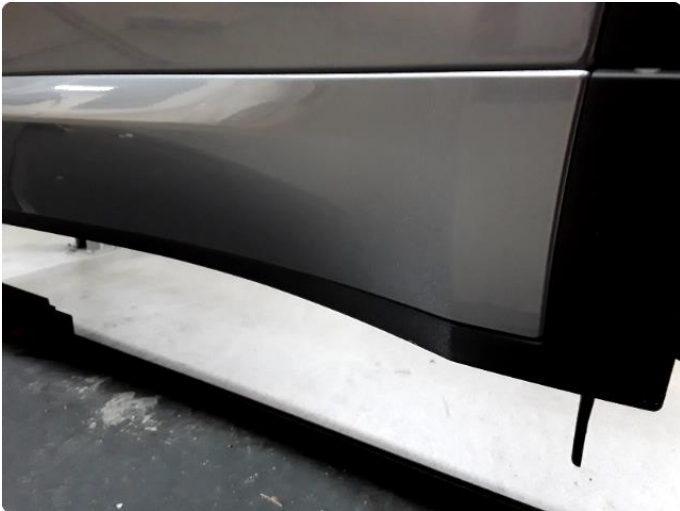
1.1 Noe slitt lakk nedkant deksler på dører
