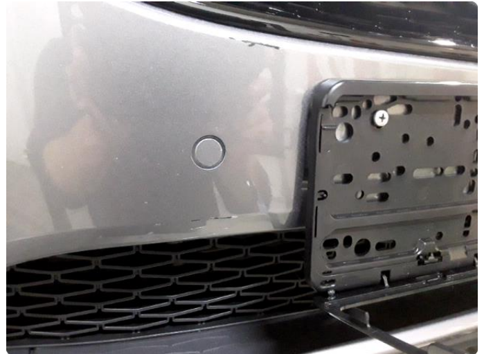
1.2 Riper gjennom lakk foran
