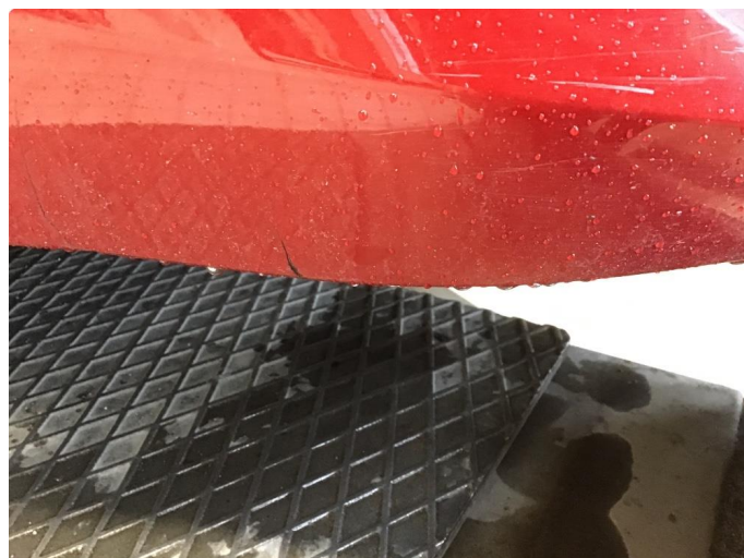
1.1 Liten sprekk i fanger
