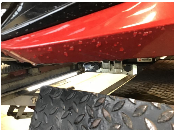
1.1 Liten sprekk i fanger
