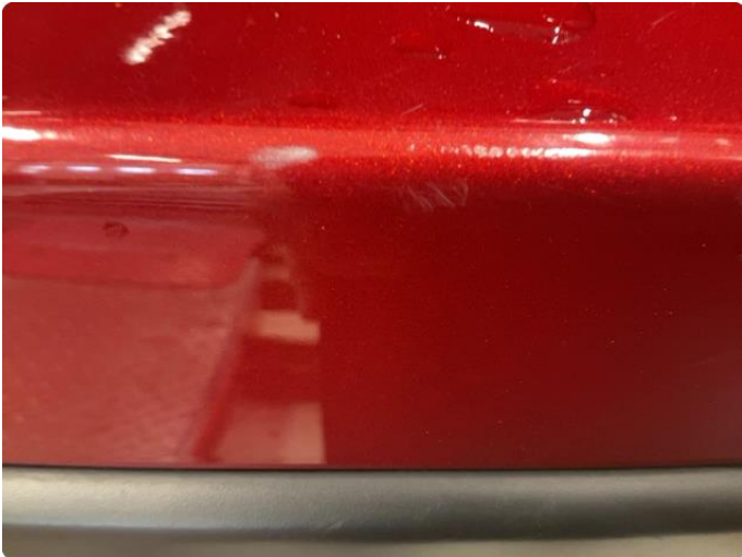
1.1 Liten lakkskade innlasting bagasjerom.
