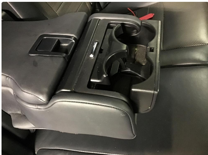
4.1 Defekt koppholder midtre armlen bak.
