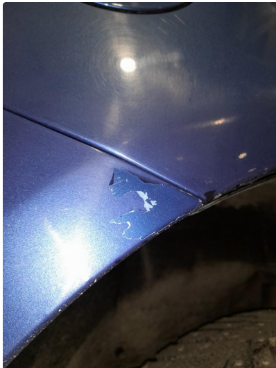
1.10 Riper og lakkskade høyre side
