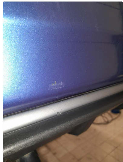
1.10 Riper og lakkskade høyre side
