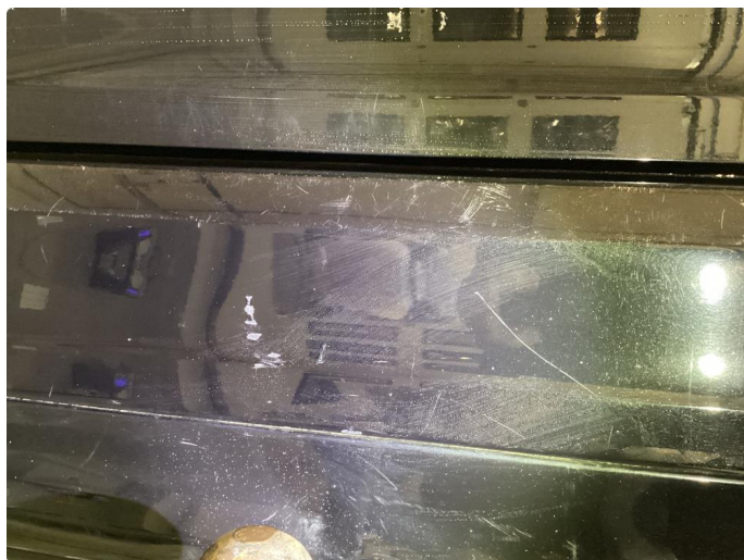
1.11 Ripe(r) ned til grunning
