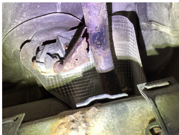
2.2 Eksosrør innfestning defekt/mangler, utbedres
