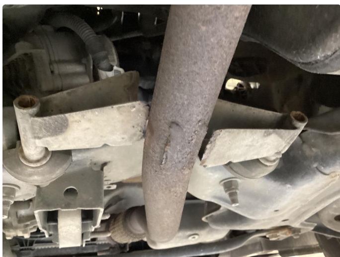
2.2 Eksosrør innfestning defekt/mangler, utbedres
