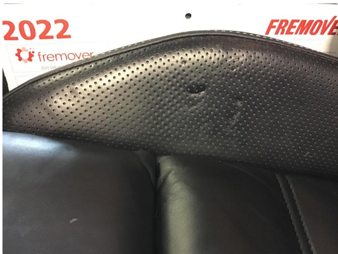
2.1 Skade på setetrekk
