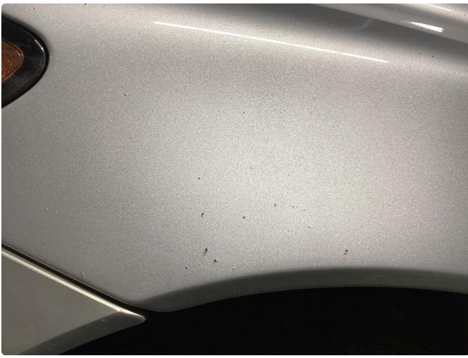
1.4 Steinsprut med rust
