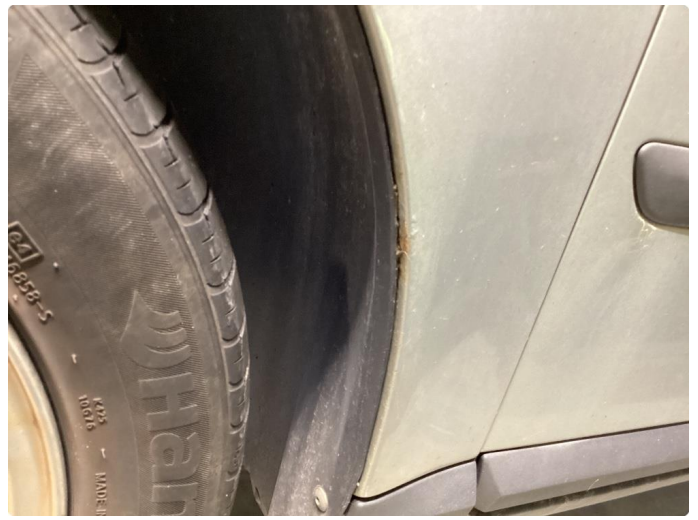
1.4 Steinsprut med rust
