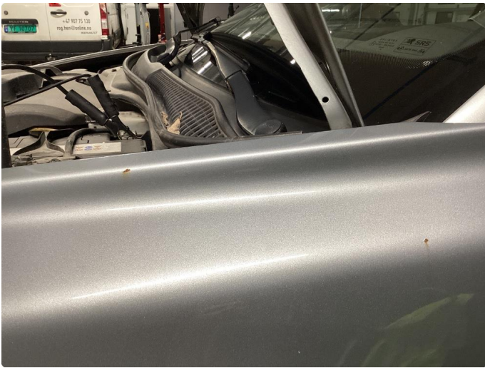
1.4 Steinsprut med rust
