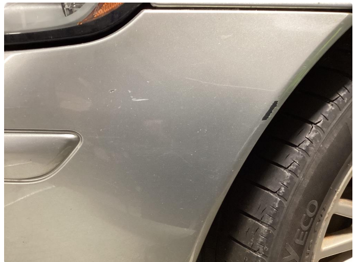
1.9 Ripe(r) ned til grunning
