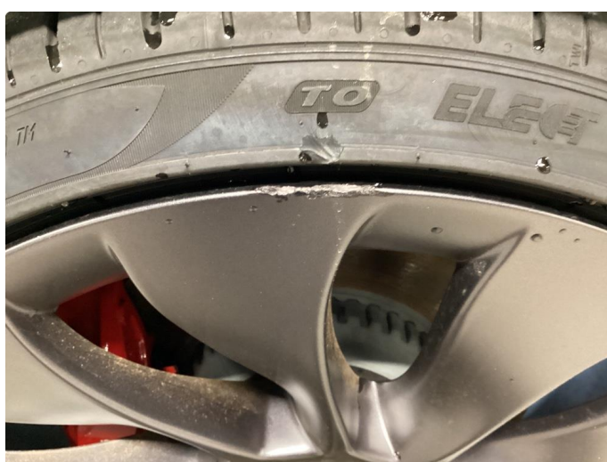
1.5 Høyre foran felg er kantkjørt
