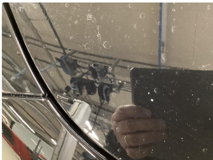
1.1 Noen steinsprut i panser
