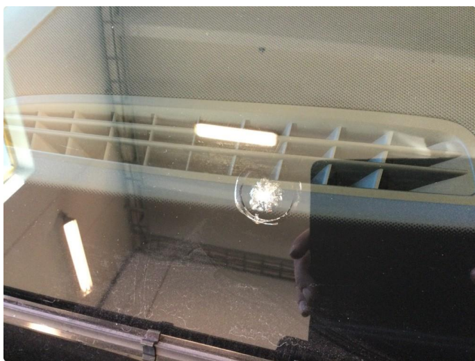
1.2 Steinsprut med sprekk
