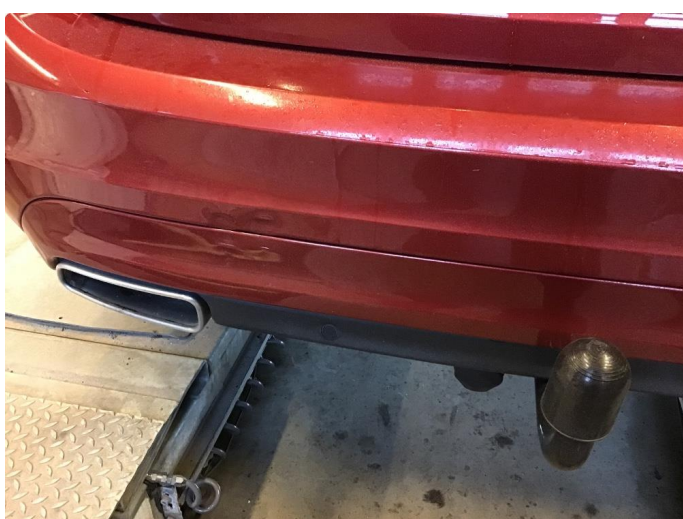
1.6 Liten bulk med lakkskade
