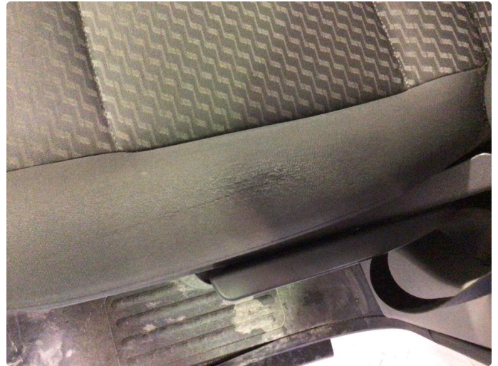
2.1 Skade på setetrekk
