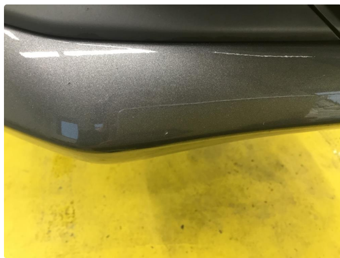
1.11 Ripe(r) ned til grunning
