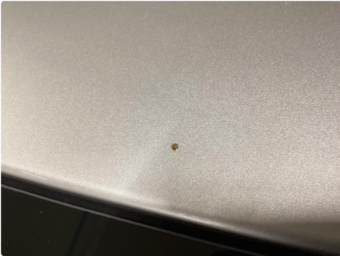
1.1 Steinsprut foran / Normal slitasje med tanke på alder / km
