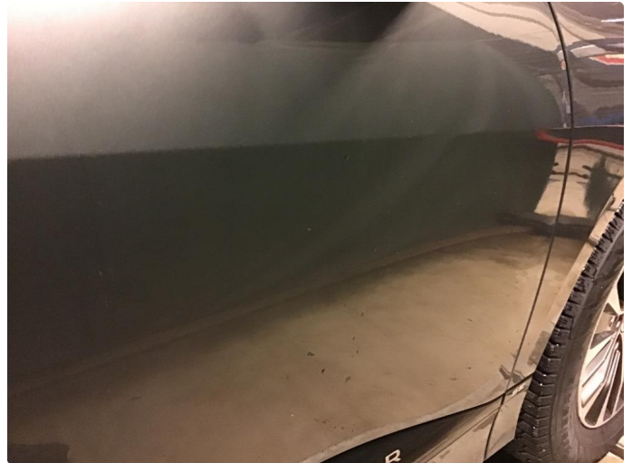
1.1 Noen riper og småbulker, polere
