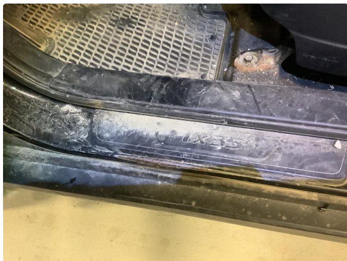
2.8 Slitt innsteg, ikke utbedret
