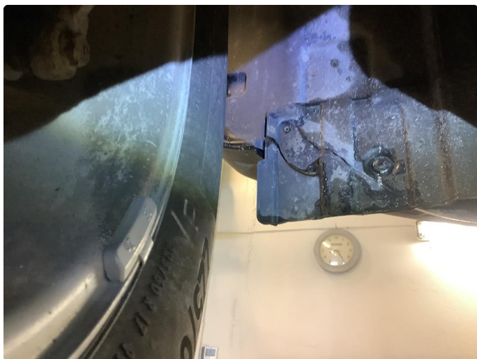
2.6 Plastinnerskjerm skadet, normal bruksslitasje
