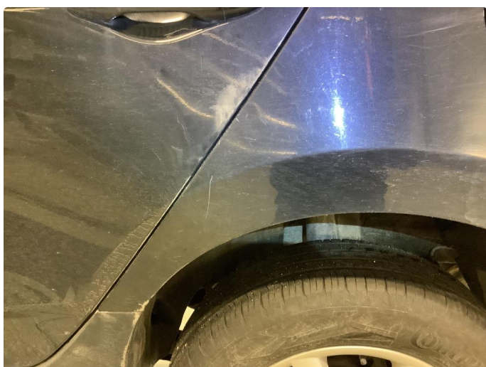
2.4 Ripe ned til grunning, ikke utbedret
