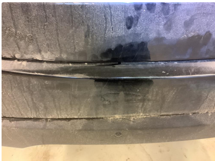
2.10 Ripe(r) ned til grunning, ikke utbedret
