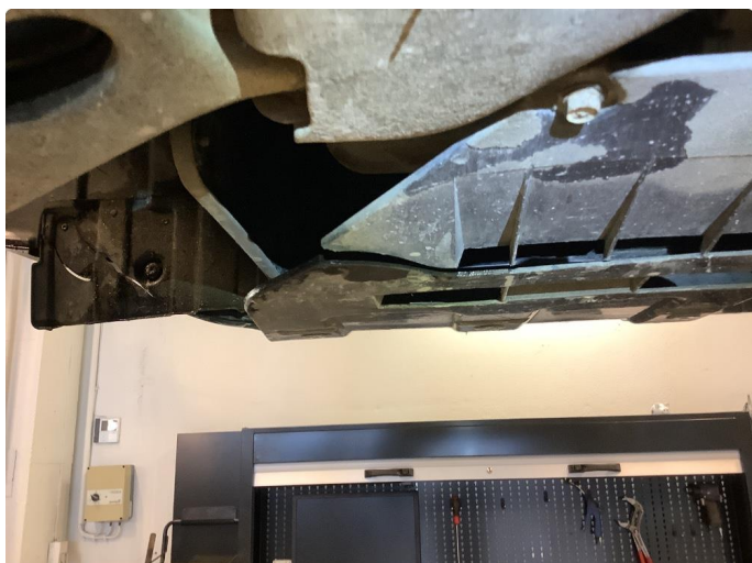
2.2 Beskyttelsesplate skadet/mangler, normal bruksslitasje
