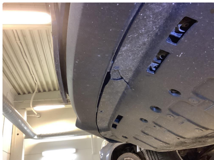
2.2 Beskyttelsesplate skadet/mangler, normal bruksslitasje
