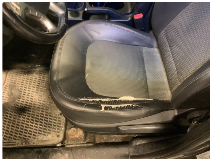
6.3 Slitt, ikke utbedret
