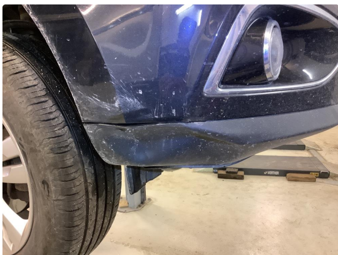
2.9 Skade, ikke utbedret. bruksslitasje
