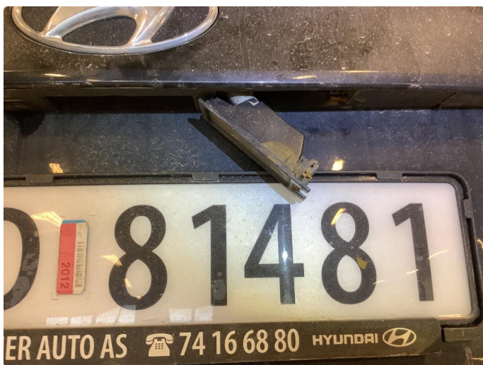
3.1 Skiltlys- skade, skiftet
