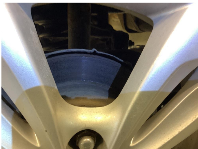
5.3 Mer enn 25% rust, skiftet
