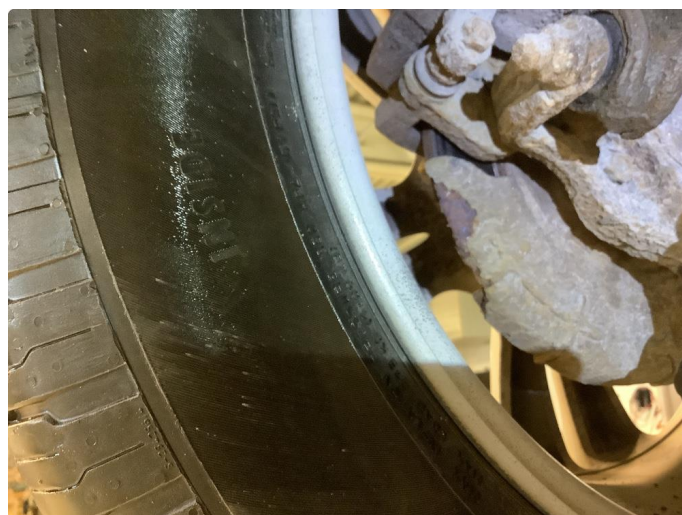
5.4 Rust, normal bruksslitasje
