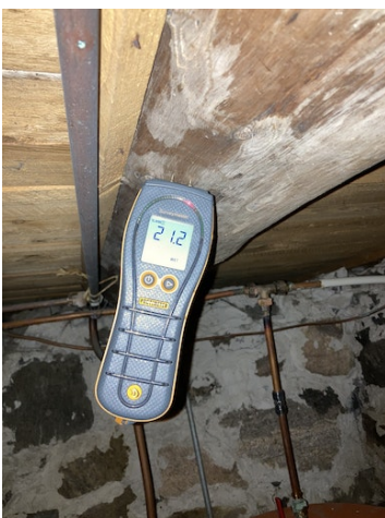
Fuktmåling utført på bjelkelag i grovkjeller.
