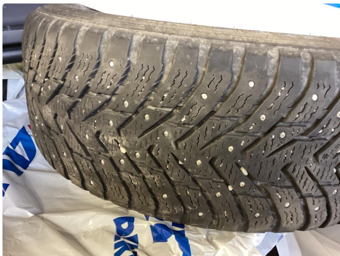
1.4 Skjev slitasje på vinterdekk
