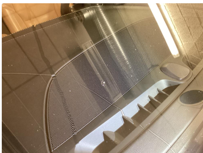
1.9 Steinsprut med sprekk
