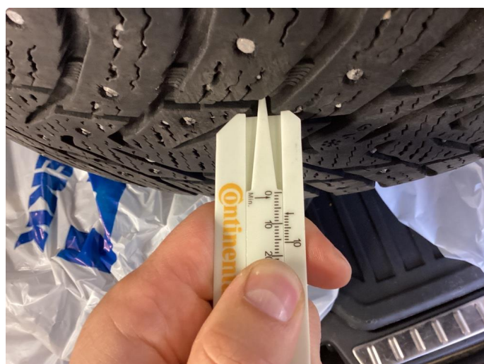
1.4 Skjev slitasje på vinterdekk
