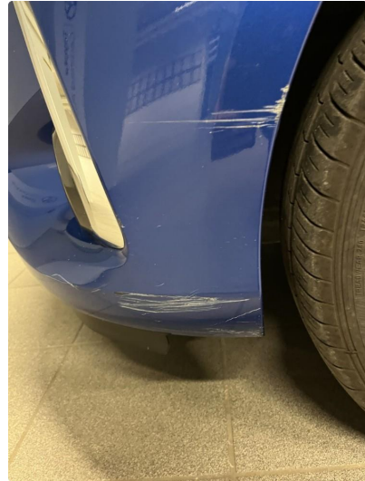
1.2 Ripe(r) ned til grunning
