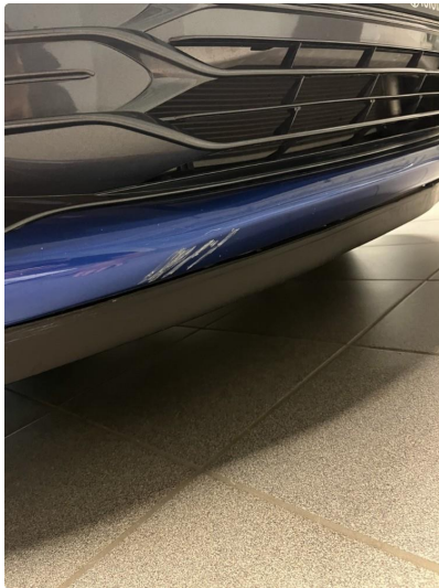
1.3 Ripe(r) ned til grunning
