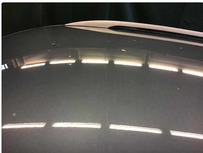
1.7 Steinsprut med rust
