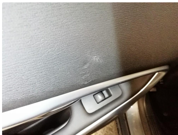
4.1 Skadet/merker etter utstyr
