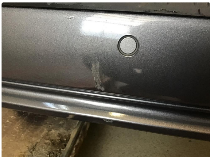
1.1 Ripe(r) ned til grunning
