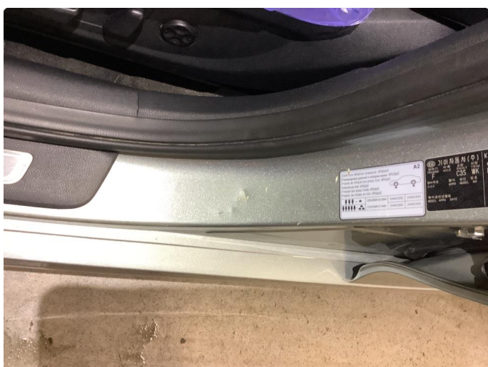
1.2 Bulk(er) med lakkskade
