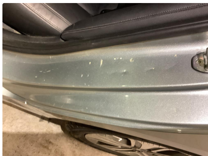
1.2 Bulk(er) med lakkskade
