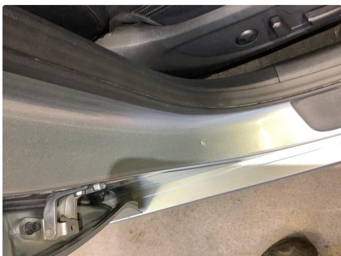
1.2 Bulk(er) med lakkskade
