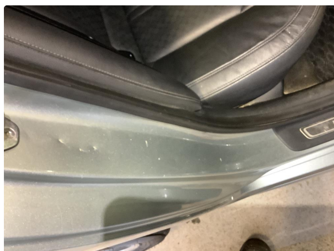
1.2 Bulk(er) med lakkskade
