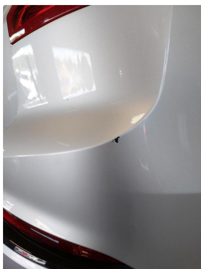
1.3 Ripe(r) ned til grunning
