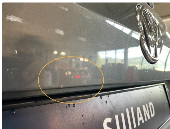
2.5 Steinsprut med rust
