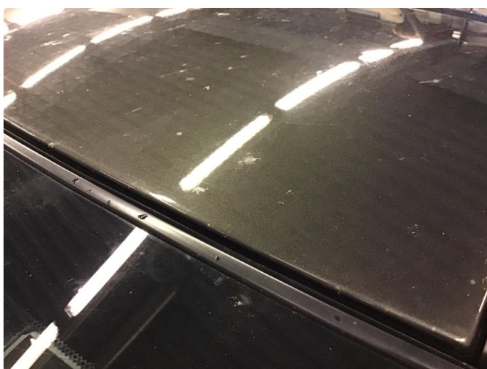
2.8 Steinsprut med rust
