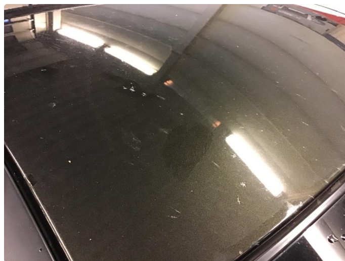
2.8 Steinsprut med rust
