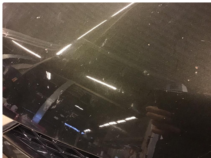
2.1 Noe steinsprut med rust
