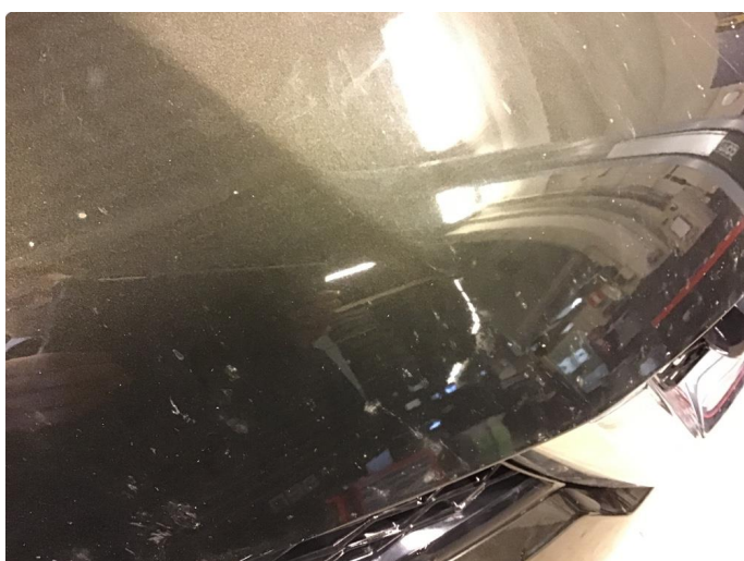
2.1 Noe steinsprut med rust
