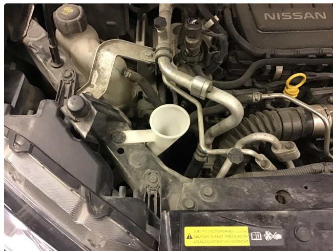
2.6 Mangler lokk til spylertank
