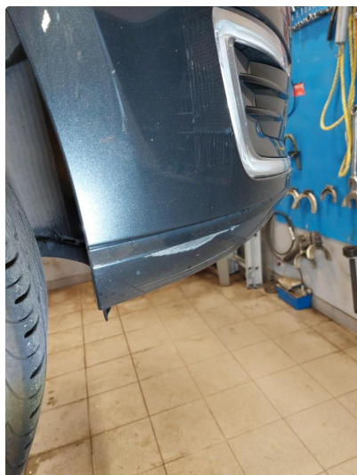
1.3 Ripe(r) ned til grunning
