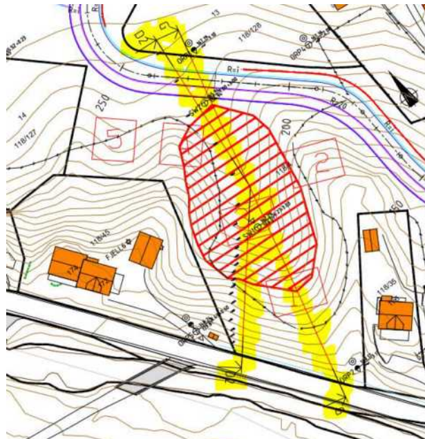
Figur 7 Skisse av nødvendig avlastning markert med rød skravur i plan
