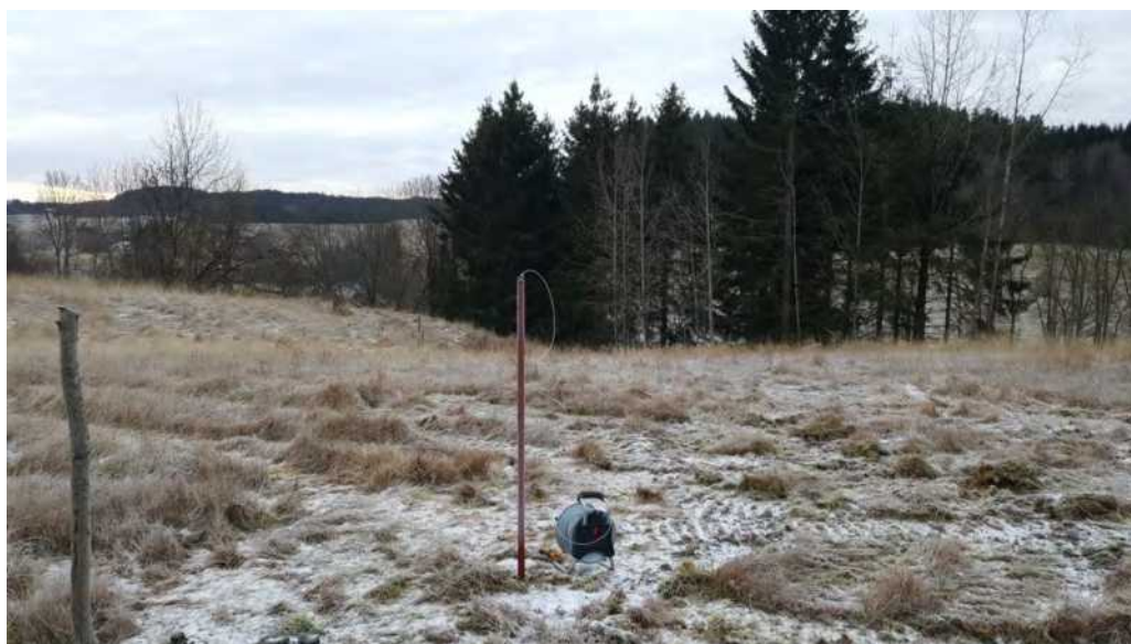
Fig. 7: Poretrykksmåling utført 06.12.2016 (sett mot ca. sørvest)
